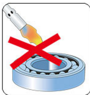
Подшипник нельзя нагревать с помощью открытого огня
