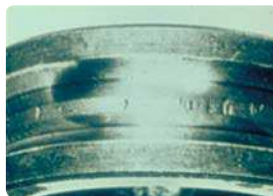
Этап 3: Перекатывание загрязнений, развитие выкрашивания поверхности.
