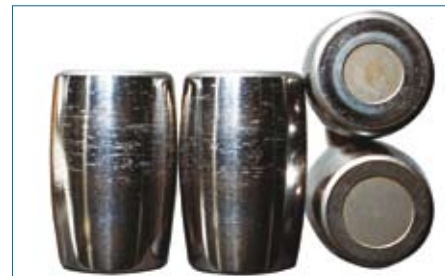
Рис. 34. Задир на торцевой поверхности качения
