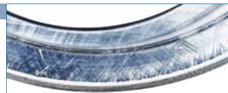
Рис. 33. Задир на поверхности ребра сферического роликоподшипника
